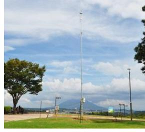
わんぱく広場の近くに「風力計」を設置しています。市再生可能エネルギー推進課が、いろいろな種類のエネルギー源を求めて調査中とのこと。8月～約3か月間試験的に風力の基礎データを集めています。
