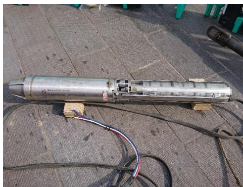
引き上げたポンプ
